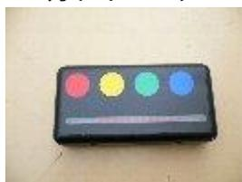
3分に1個のランプが消えます。(タイマー設定に到達するまで順にLEDランプが消えていきます。設定時間に到達すると、アラームが鳴ります。)
