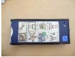
8個のキーを持つVOCA。合計60秒間のメッセージを録音できます。直接キーを押して発声させる方法と、各部メッセージに対して外部スイッチをつないで発声させる方法とがあります。コミュニケーションや見通しをもたせるためのツールとして使えます
