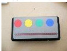
1分に1個のランプが消えます。(タイマー設定に到達するまで順にLEDランプが消えていきます。設定時間に到達すると、アラームが鳴ります。)
