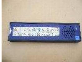
8個のキーを持つVOCA。合計60秒間のメッセージを録音できます。直接キーを押して発声させる方法と、各部メッセージに対して外部スイッチをつないで発声させる方法とがあります。
